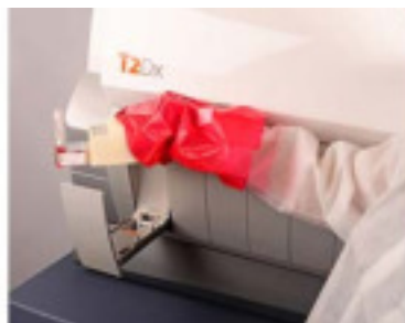
Abbildung 4. Richtige Methode für das Entladen eines Assays
